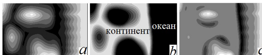
Рис. 2. Распределения на внешней поверхности при 3D-моделировании: a ) температура (светлая – горячая), b ) рельеф коры (светлый – высокий), c ) растяжения (светлые) – сжатия (темные)
